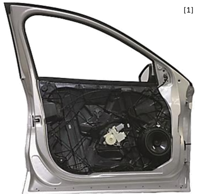
Fig. 1: Polymer door module in steel door main structure
