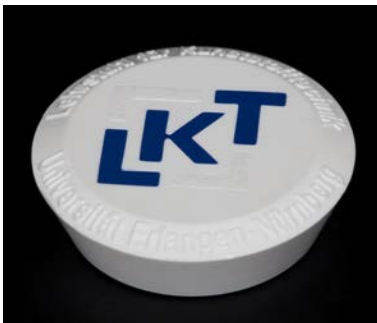
Herstellung im Einlegeverfahren auf einer 1K-Spritzgießmaschine
