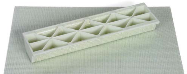
Erlanger Träger, optimiert für Kunststoff/ FVK-Hybridstrukturen
