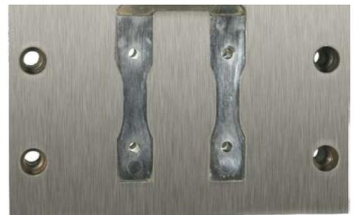
Werkzeugeinsatz für Kleinprobenwerkzeug
