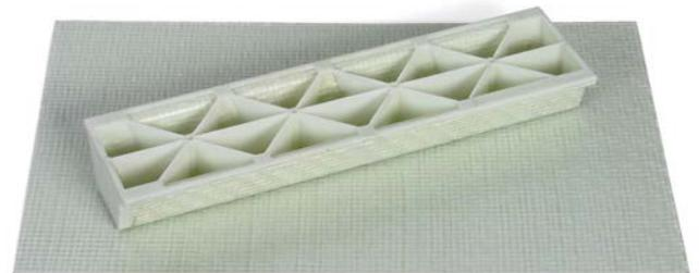
Erlanger Träger, optimiert für Kunststoff/ FVK-Hybridstrukturen
