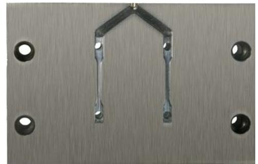
Werkzeugeinsatz für Mikroprobenwerkzeug
