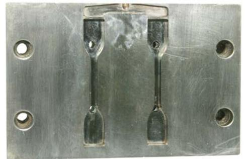
Werkzeugeinsatz für Kleinprobenwerkzeug
