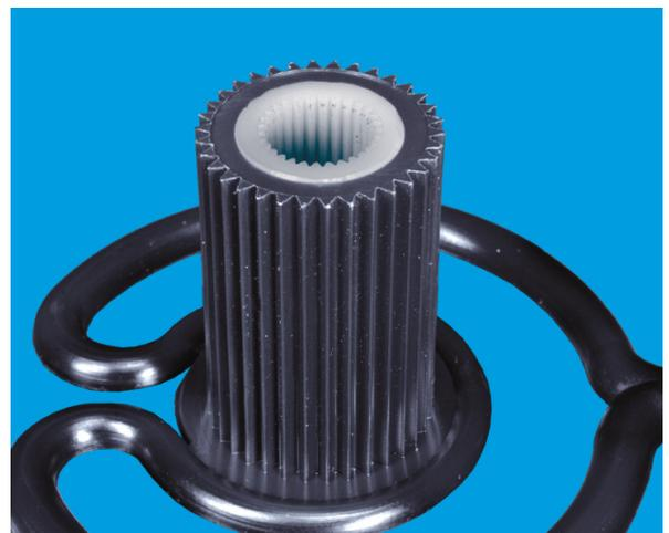
HT-Schubprobekörper mit Anguss
