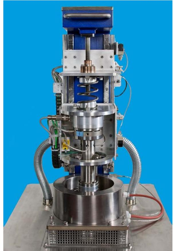
Prüfstand mit Wärmekammer
