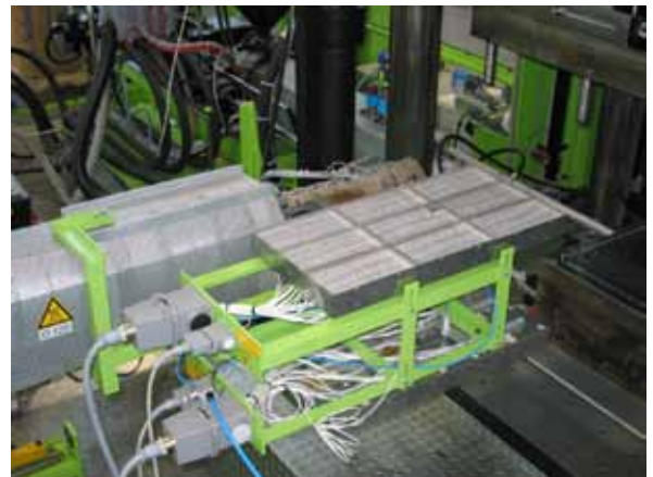
Strahlerfeld an der Spritzpresse
