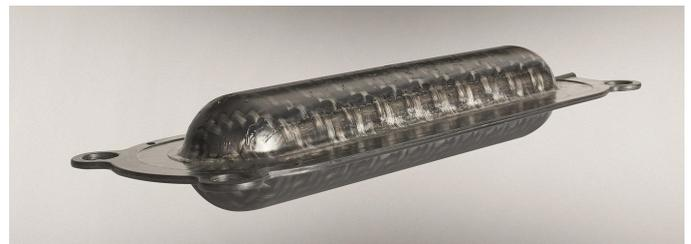
Im Twin-O-Sheet Verfahren hergestellter Probekörper
