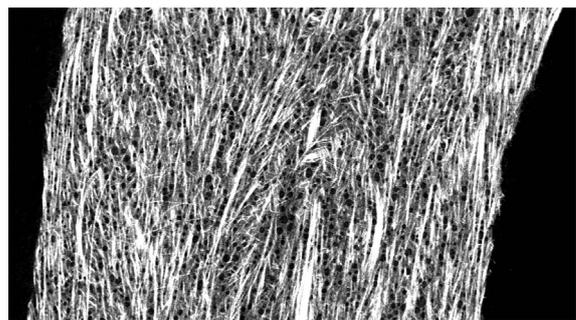
*Sub $\mu$ CT-Aufnahme eines LFT-Schaums (10x-Vergrößerung)*
